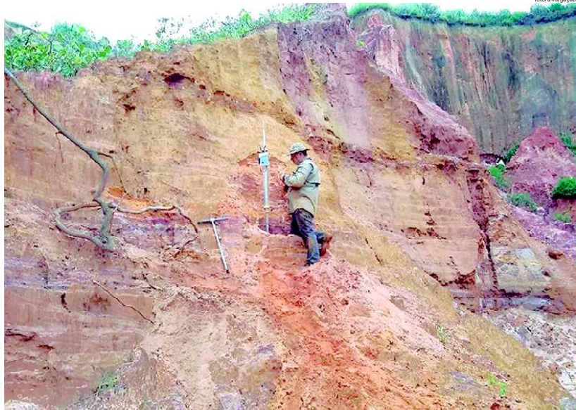
O novo permeâmetro avalia a condutividade hidráulica do solo, ou seja, mede a capacidade da água fluir dentro do solo, por meio de recursos digitais e um microcomputador de baixo custo
